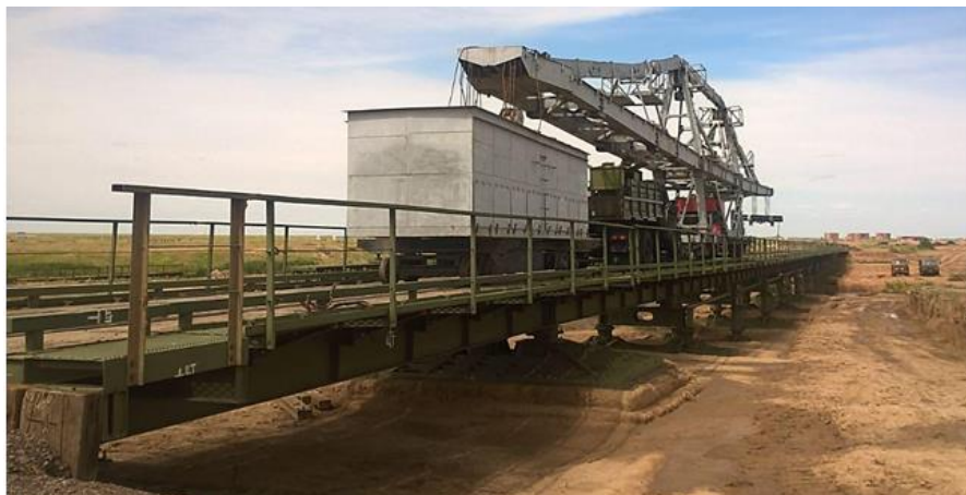
Рис. 1. Консольный кран СРК-50 на мосту-эстакаде железнодорожном ИМЖ-500
